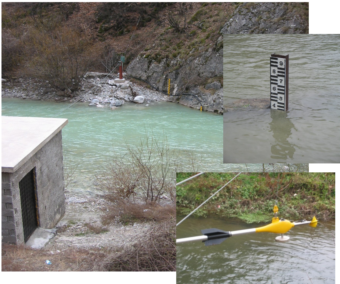
Stacioni hidrometrik në lumin Bistrica e Pejës – Gryk e Rugovës, (Sistemi i vinçit për matjen e rrjedhës së ujit)
